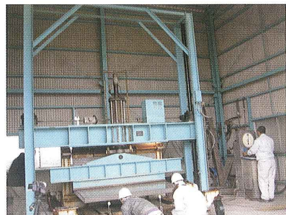
曲げ破壊試験の実施状況
