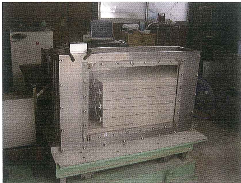
使用した振動台実験装置と土槽
