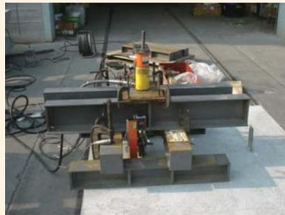
【コネクティブの引抜耐力試験】
