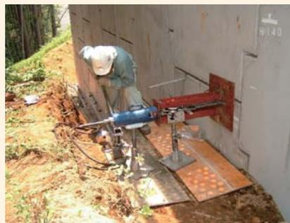
【幅広ストリップの引抜き試験状況】
