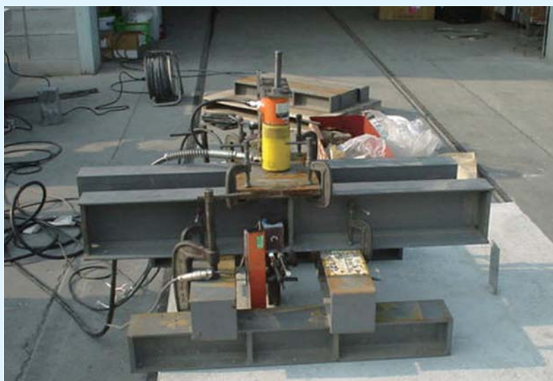
【コネクティブの引抜耐力試験】
